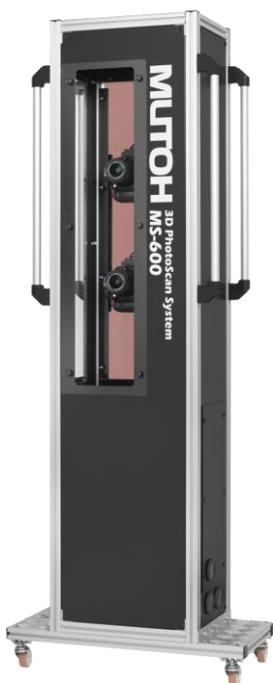
今般発売を開始する「MS-600N/PX」は、弊社が開発した同時シャッターユニットで、撮影間隔や回数を任意に設定でき、回転速度が安定した回転テーブル（同梱）により、対象物を確実に撮影できるスキャナーユニットです。撮影に要する時間はわずか60秒。撮影範囲は100mm角～400mm角（標準仕様：カメラ2台）ですが、カメラを増設すれば、最大600mm角まで対応可能です。また、撮影に必要な照明やブルーバックカーテンも標準でパッケージ化されています。
