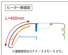
フロントペーパーガイドの裏側に大型デュアルヒーターを上下に配置。ヒーターの温度は、パネルから個別に設定できます。印字動作を止めることなく、温度の確認および設定を変更することも可能です。
