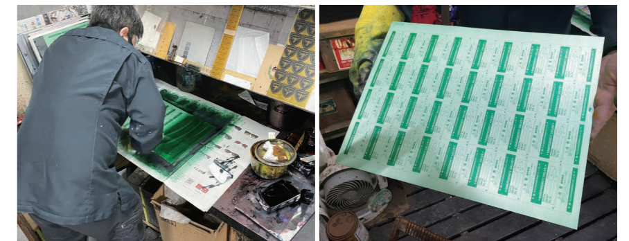
金属銘板の製作は、このような手作業が中心。
