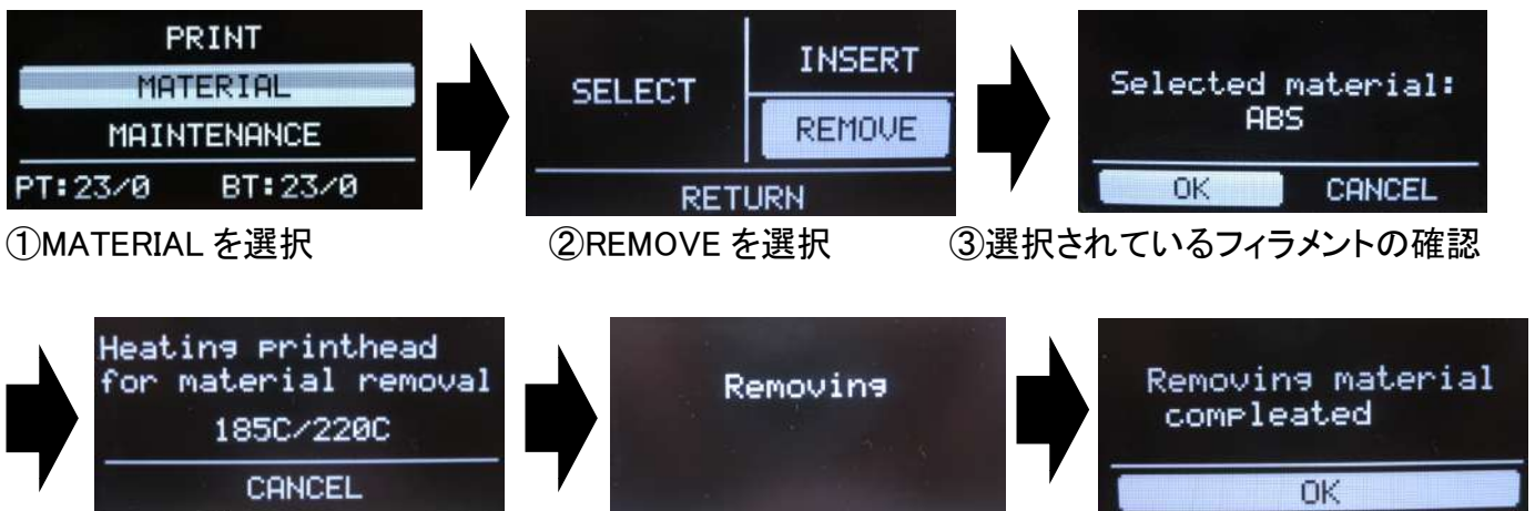
図 6.6 フィラメントの取り外し
