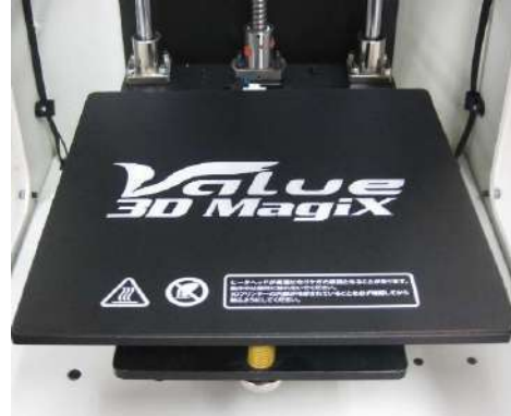
左図にマグネット定着シート貼り付ける
