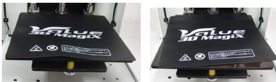
図 4.2 誤ったマグネット定着シートの貼り付け
