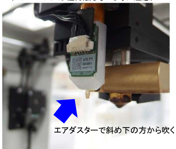
図 10.3 Zプローブセンサーのゴミの除去 (Zプローブには極力触らないように注意)
