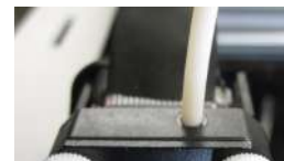
図 6.4 フィラメントチューブをエクストルーダ上部に固定
