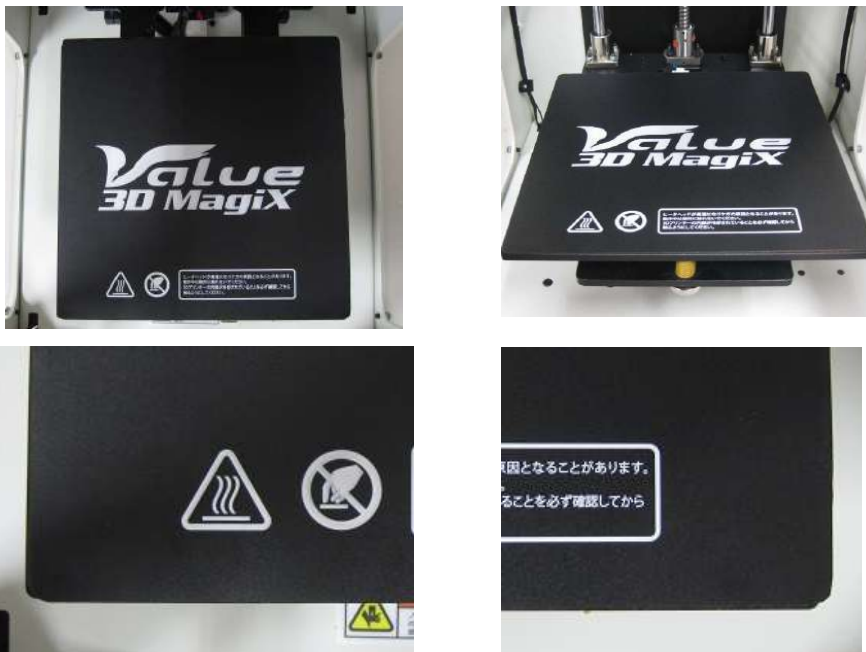
図 4.1 正しいマグネット定着シートの貼り付け方
