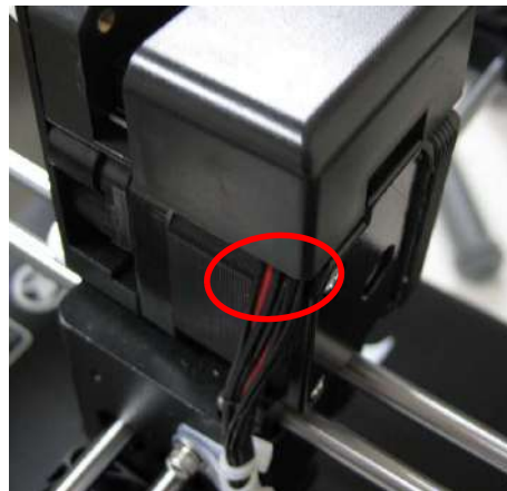
図 9.2 コネクタカバー取り付け
