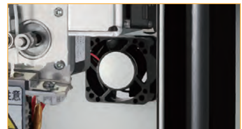
The cooling fan
